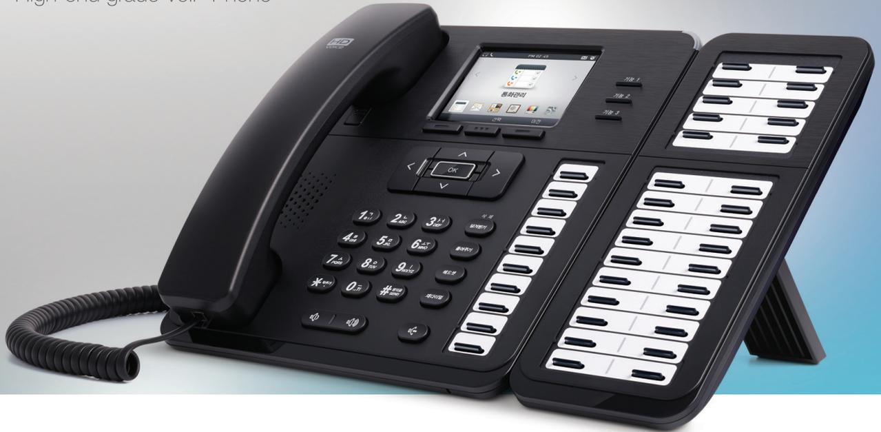
**IP700**은 3.5인치 컬러 LCD를 탑재한 관리자급의 고급형 VoIP단말로 다양한 어플리케이션 응용을 위해 USB 호스트를 지원하며, 모임스톤 UC와의 완벽한 호환성을 확보하고 있습니다. 또한,기가 이더넷을 기본으로 탑재하여 빠른 네트워크 처리속도를 보장하며, PoE 및 BLF 확장 키 모듈을 옵션으로 제공하는 기업용 솔루션에 최적화된 제품입니다. 그리고 다양한 사무환경에서 사용할 수 있도록 IMS, IPv6, AMR-WB, Security, Google Contact Sync, Multi-line 등의 사업자 요구사항을 기본사양으로 제공하는 가장 진보적인 기업용 IP-Phone입니다.
